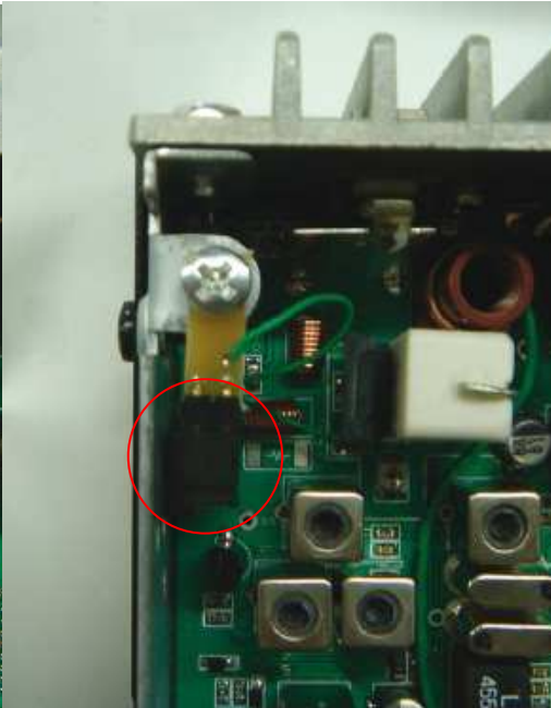
4 Watt Brücke beidseitig
